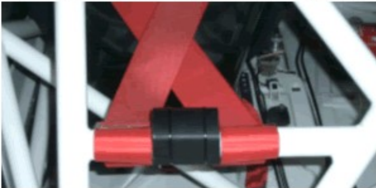
Beispiel eines Abstandshalters mit RA 88-57-2001 Polstermaterial
